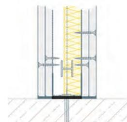
WS 2.90 TITI = Wand WH-PoC System Einfachständerwand Titanboard mit und ohne Mineralwolle im Brandschutz geprüft, Statik geprüft.
