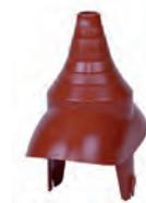
Der Venduct Antennendurchgang überzeugt durch passgenaue, schnelle Montage und UV-beständiges PVC und jahrzehntelange Funktionssicherheit. Die optimale Durchführung für Durchgangs-Abstufungen von 22,2 mm, 27,8 mm, 34,7 mm, 43,3 mm, 49,0 mm, 61,4 mm und 77,5 mm von Antennen- und Satellitenempfangsmasten.
