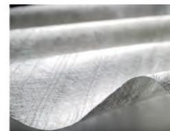
Das Herstellungsverfahren garantiert den konsequenten Einsatz hochwertiger Rohstoffe. Daher sind TS Geotextilien beständig gegenüber fast allen üblicherweise in Böden und Baustoffen vorkommenden chemischen und biologischen Substanzen.
