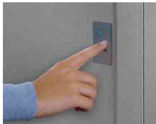
Öffnung über einem im Türblatt eingebauten Fingerleser
