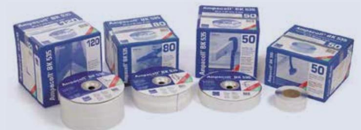
Grundmaterial: Butylkautschuk Farbe: Blau Lagerfähigkeit: 2 Jahre Freibewitterungszeit: 3 Monate Reißdehnung: > 300% Lagerung: kühl und trocken Verarbeitungstemperatur: ab 0°C Temperaturbeständigkeit: -40° C bis +90° C Alterungsbeständigkeit: >20 Jahre Kartoninhalt: 12 Rollen = 60 lfm Dicke: 2 mm
