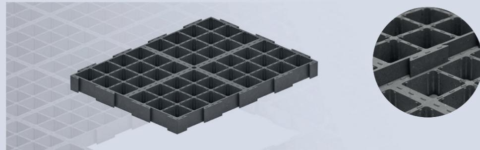
Mit dem MT60-Bodensystem lassen sich Böden und Oberflächen befestigen, ohne ihre natürlichen Funktionen einzuschränken. Das System ist bis zu 40 Tonnen belastbar und verfügt über eine Schwalbenschwanz-Verbindung für einfache Verlegung.
