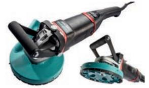
Liegt gut in der Hand für kontrolliertes Schleifen. Für umfangreiche Schleifarbeiten mit schnellen Ergebnissen. Verstellbarer Handgriff mit Schwingungsdämpfung zur Reduzierung der Vibrationen; mit Metallschutzhaube, Lamellenring und Absaugstutzen für effektives Absaugen des Schleifstaubs. Ausgestattet mit Sanftanlauf, Anlaufstrombegrenzung, Wiederanlauf- und Überlastschutz; Abschaltkohlen; Warn-LED bei Überlastbetrieb.
